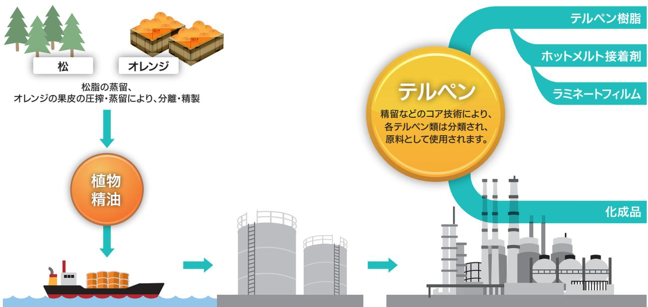
オレンジジュースの副産物であるオレンジオイルと、松脂や松のチップなどから採取されるテレピン油を原料として、各種テルペン成分を分離精製しています。
